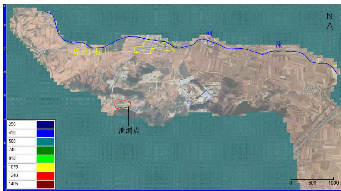
图7.3-42 渗漏2000天污染影响范围（氯化物）
