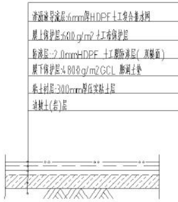
图3.3-8 边坡防渗结构图
