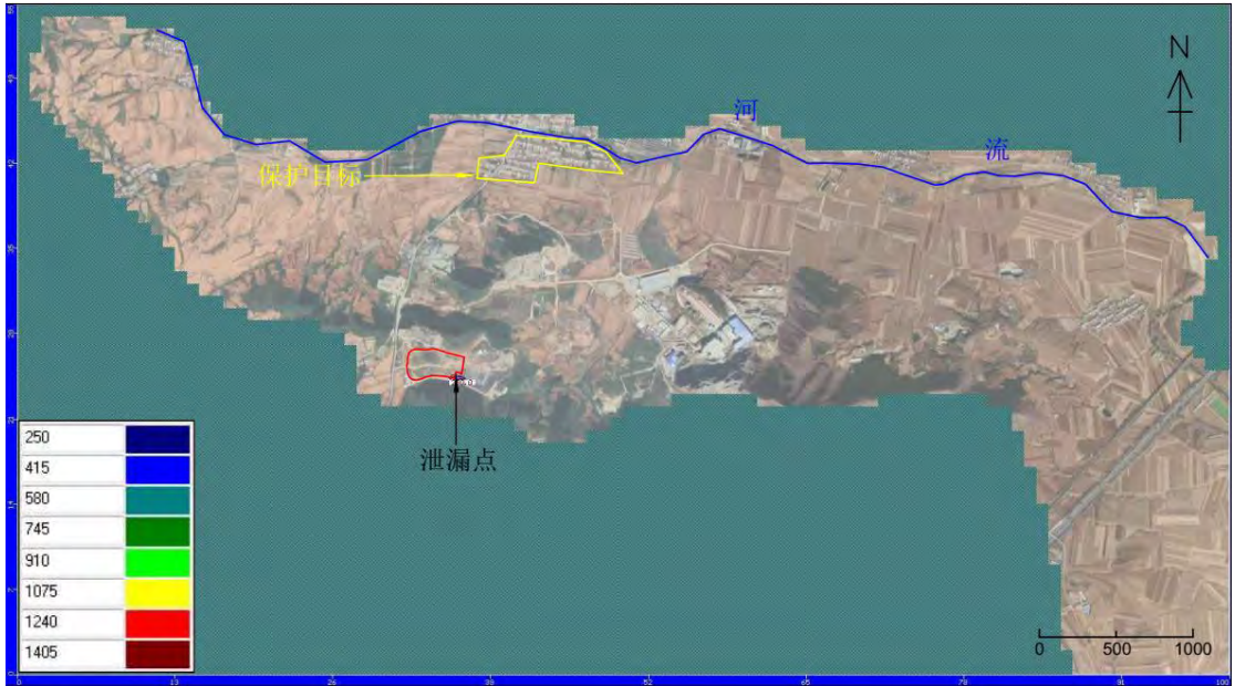
图 7.3-36 渗漏35天污染影响范围（氯化物）
