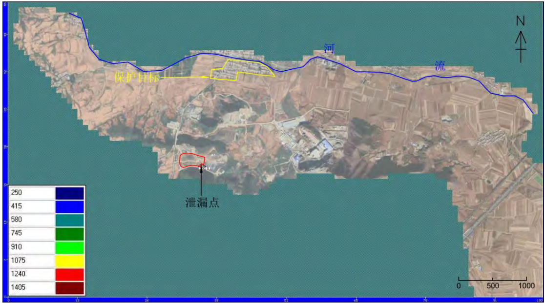
图 7.3-35 渗漏30天污染影响范围（氯化物）
