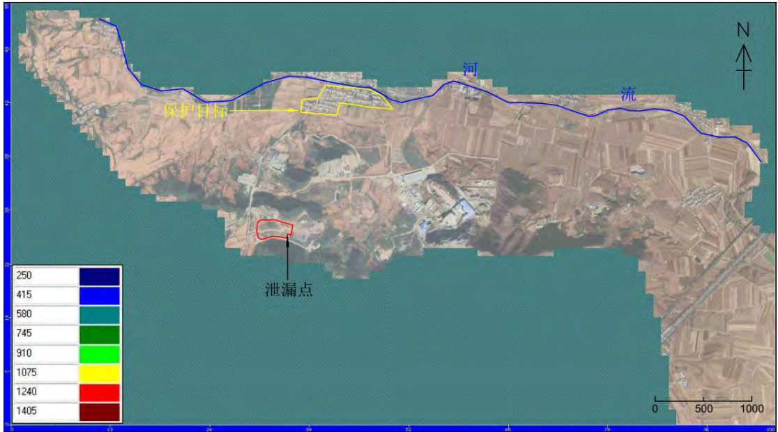
图7.3-40 渗漏100天污染影响范围（氯化物）
