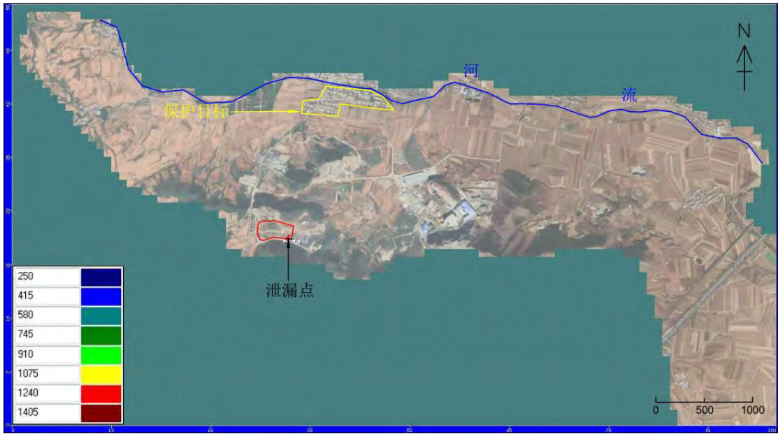
图 7.3-37 渗漏38天污染影响范围（氯化物）
