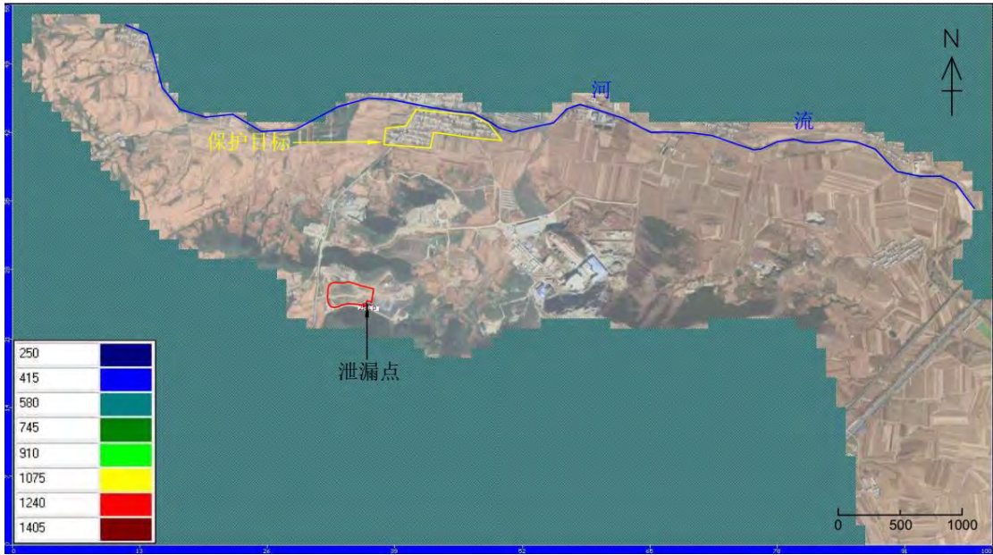
图 7.3-34 渗漏10天污染影响范围（氯化物）
