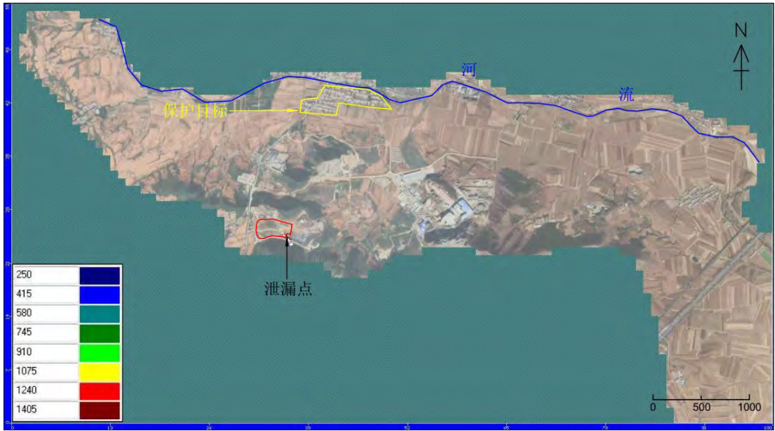
图 7.3-38 渗漏40天污染影响范围（氯化物）
