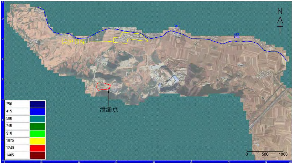
图 7.3-39 渗漏42天污染影响范围（氯化物）
