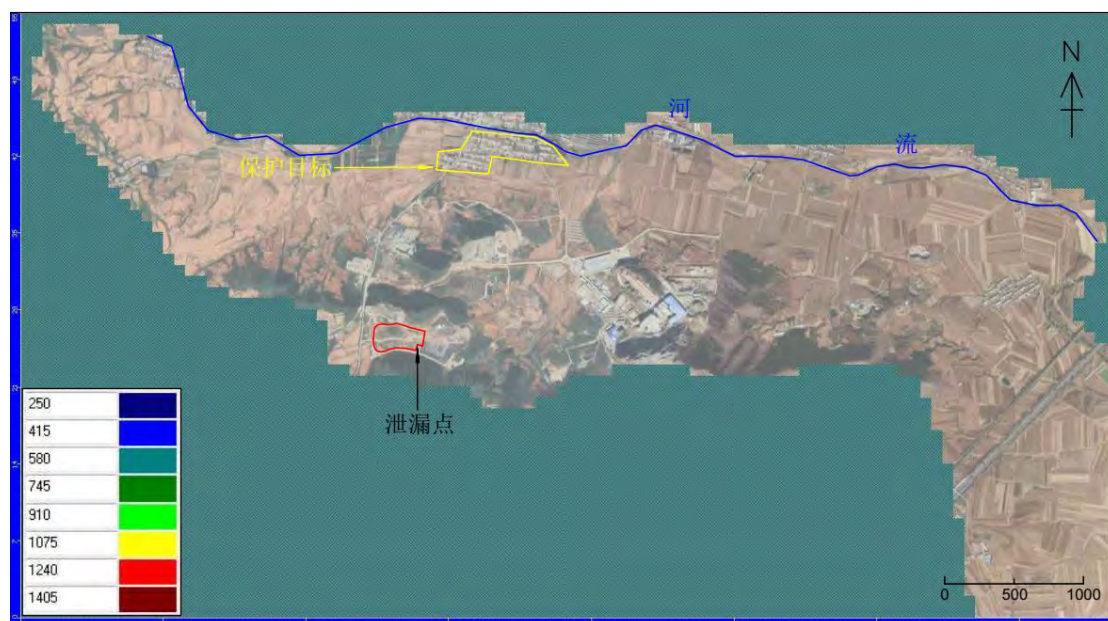
图7.3-41 渗漏1000天污染影响范围（氯化物）
