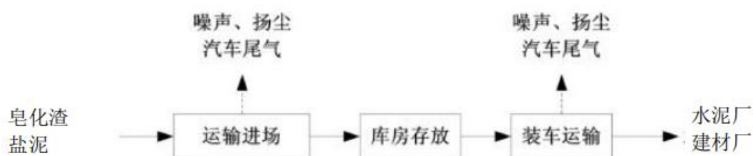
图 3.5-1 工艺流程图及产污节点
